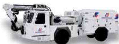
Подземные смесительно-зарядные машины
